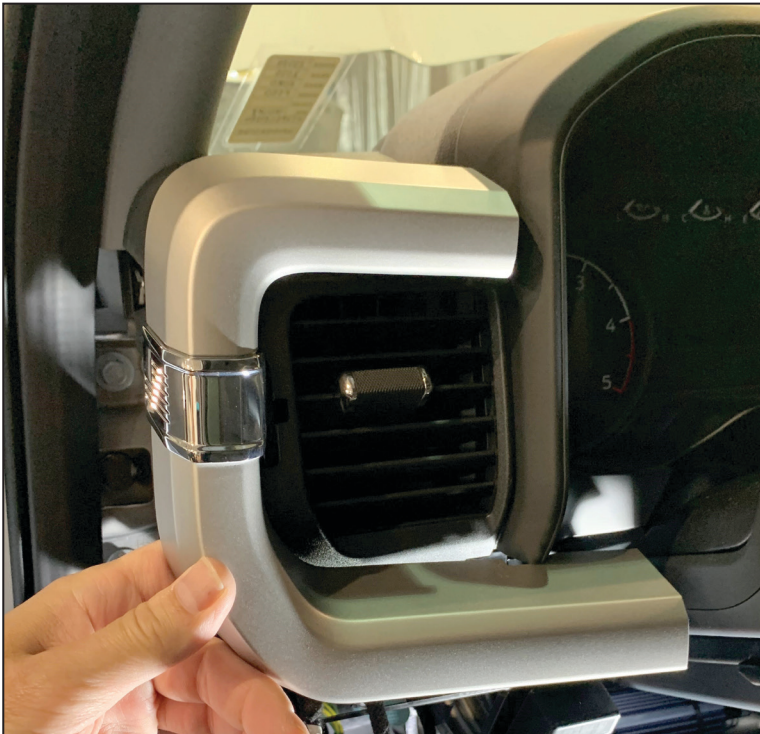
Figure 44 — Remove vent bezel
